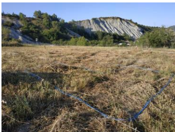
Sondeos electromagnéticos en dominio del tiempo (TDEM). Investigación. Foto cedida por Pilar Muñoz.
