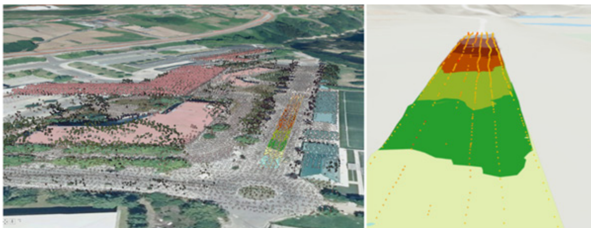
Nube de puntos GPR (espesor de firme) e MDE sobre nube de puntos LiDAR
